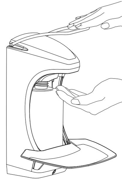
Halten Sie die Hand unter die Auslaufblende und betätigen Sie den Bedienhebel.
